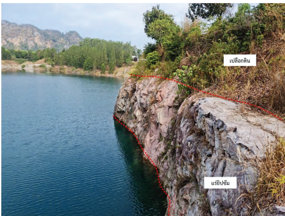
รูปที่ 3 การวางตัวของชั้นแร่ยิปซัมและเปลือกดินของผนังบ่อเหมืองในปัจจุบัน (มองไปทางทิศตะวันตกเฉียงเหนือ)
